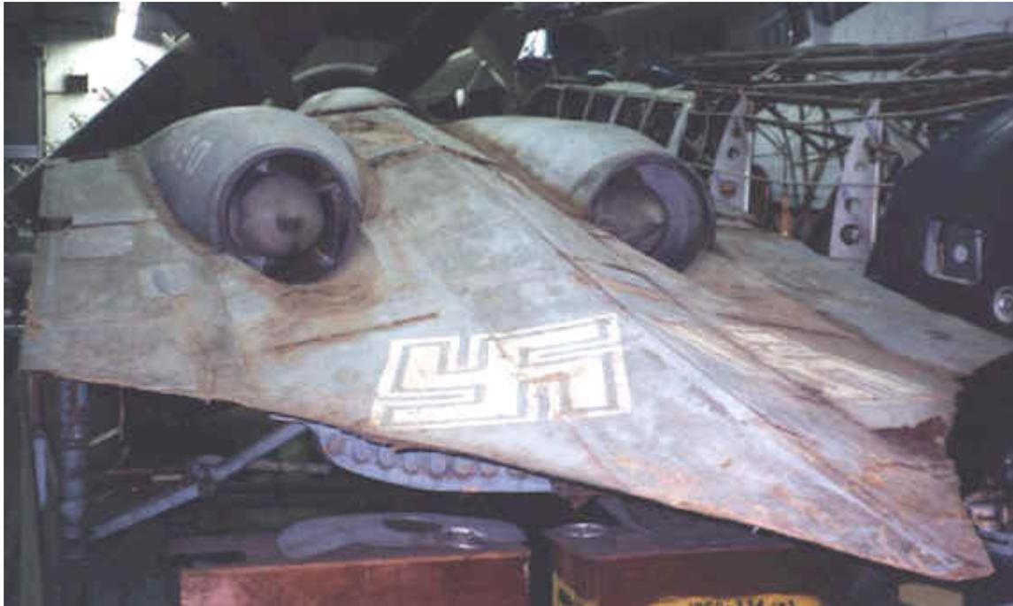
Foto 14 - Another view of the tail shows a pronounced fuselage spine, and the blast tubes of two Jumo engines. La foto e' recentissima e mostra la fantascientifica parte centrale dell'Horten V3 catturato dagli americani. Caduto il segreto militare, tale reperto bellico e' oggi visibile di 'persona' previa richiesta.
